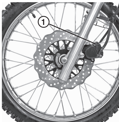
Рис. 13. Дисковый тормоз переднего колеса
