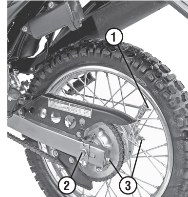
Рис. 14. Регулировка заднего тормоза и натяжения цепи
